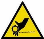
**Pericolo.** Organi in movimento. Pericolo di schiacciamenti arti superiori durante il funzionamento del motore principale. Non inserire mai le mani al di sotto della macchina sterilizzatrice mentre il motore principale è in funzione.
