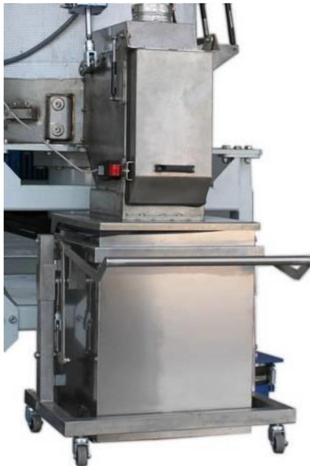
**Fig. 4 - Discharge Vessel**
