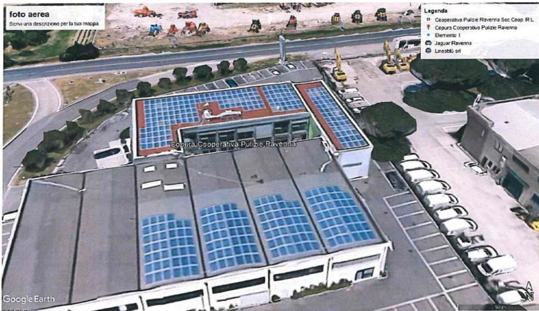
*Foto impianti, sull'edificio con la copertura rossa l'impianto da 49,20kWp mentre in basso sono ubicati gli altri due impianti divisi tra impianto 1 a dx e impianto 2 a sx.*
